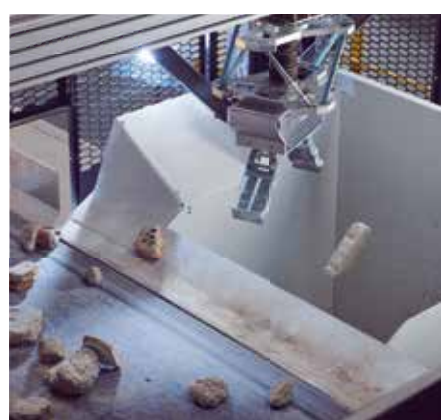
www.terex.com/zenrobotics, plastic sorteer robot: waarbij AI wordt ingezet voor het sorteerproces
